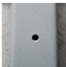
Trou métrique pour la fixation au châssis supérieur
