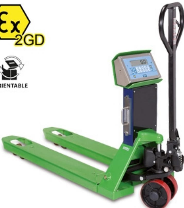
Transpalette peseur ATEX pour utilisation en zones dangereuses (ZONES 1 et 21 & 2 et 22) avec protection Ex II 2G IIB T4 Gb X et Ex II 2D IIIC T197°C Db X.
